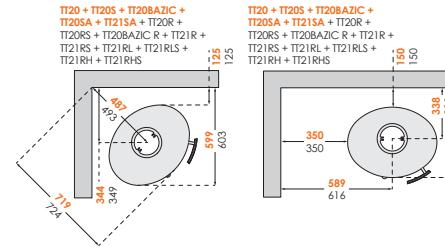
Les distances de sécurité minimales aux objets inflammables sont indiquées sur la plaque d'identité du poêle, elles ne doivent pas être inférieures aux valeurs préconisées.
