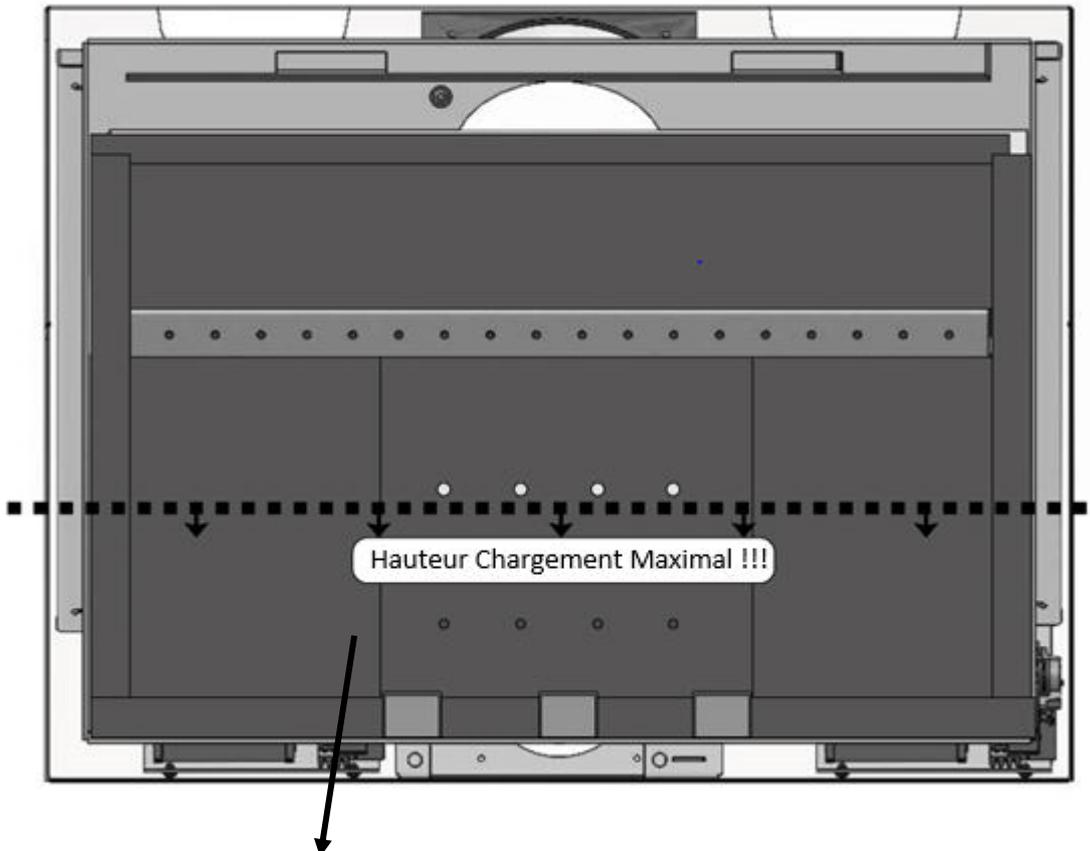
Afin d'éviter la **surchauffe**, la **ligne ne doit pas être dépassée** lors du remplissage des bûches et la rangée supérieure de trous doit toujours rester visible.
